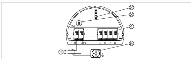
Отсек электроники и подключения (однокамерный корпус)
